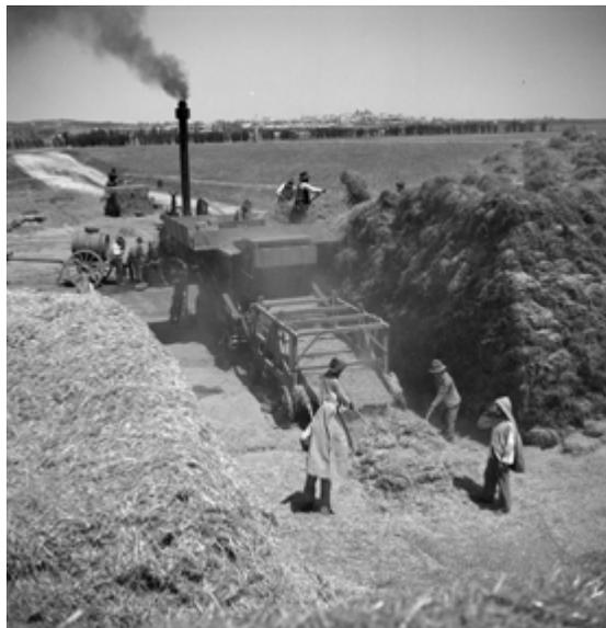
...no século XIX, surgiu outro sistema, em que um motor a vapor accionava uma máquina complicada, a debulhadora fixa;...
